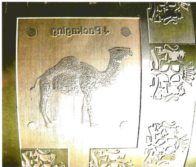
Rotative Prägeformen im zwei- oder dreidimensionalen Bereich werden direkt in Aluminium oder Kupfer hergestellt. MLZ-Foto
